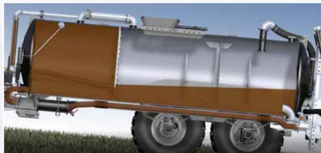
Sobald der Güllespiegel in der hinteren Kammer soweit abgesunken ist, dass Luft über die Öffnung der Trennwand in die vordere Kammer gelangen kann, erfolgt die restliche Entleerung.
