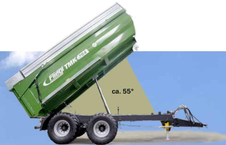
Der Tandem TMK 269 Profi mit einer Muldenlänge von 6,90 m und einem Kippwinkel von ca. 55°
